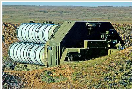
Пусковая установка ЗРС С-300 Фото: Георгий ДИНИЛОВ
